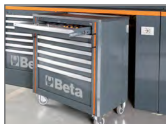
Szerszámkocsi. A kezelő könnyen előhúzhatja a 2 rögzített és 2 elforgatható kerék segítségével
